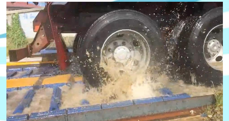
⑥通過するだけで、タイヤが洗淨される
